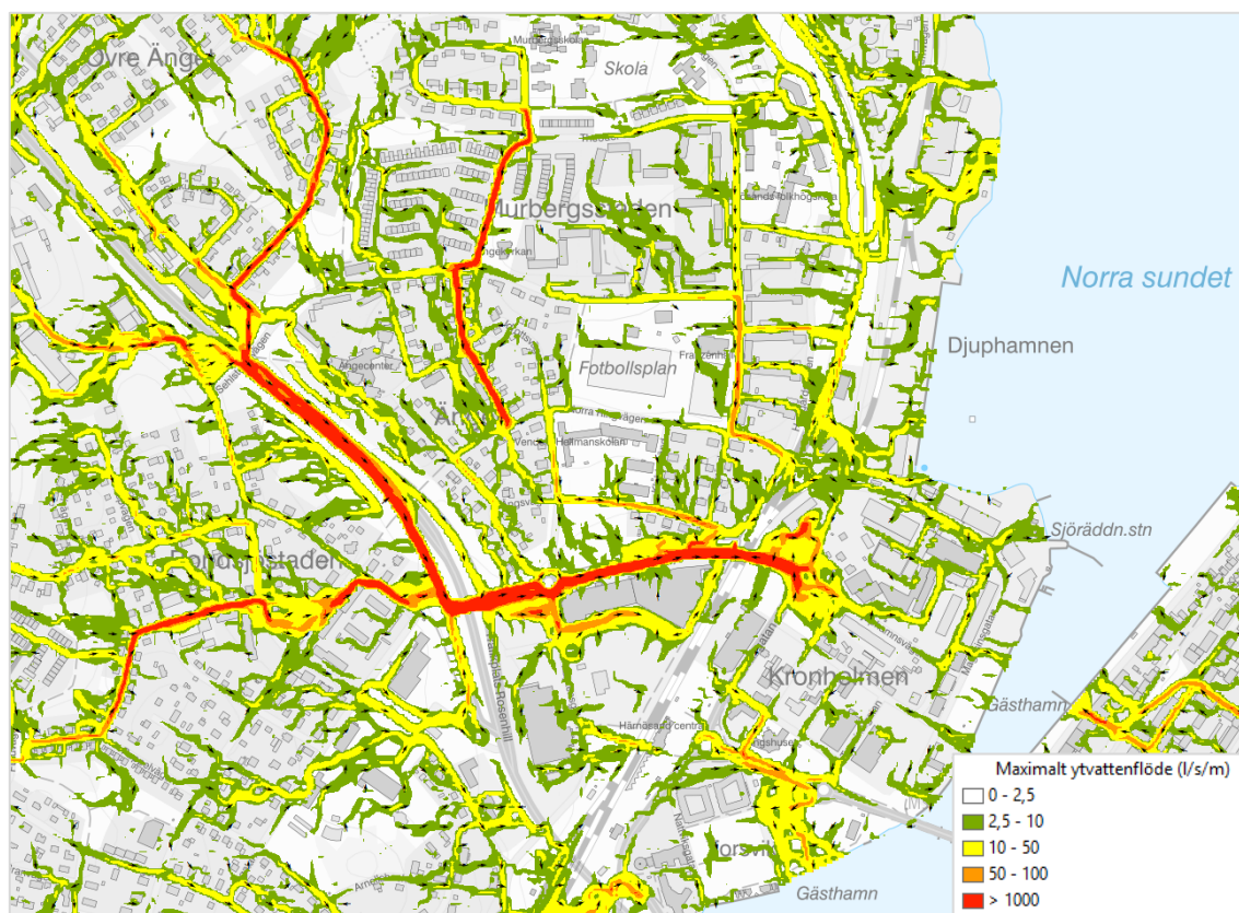
Figur 3-2. Resultatexempel för beräknade maximala ytvattenflöden och flödespilar. Exempelbilden visar resultat för modellberäkning med framtida 100-årsregn (kopplad ledningsnäts- och markavrinningsmodell).
