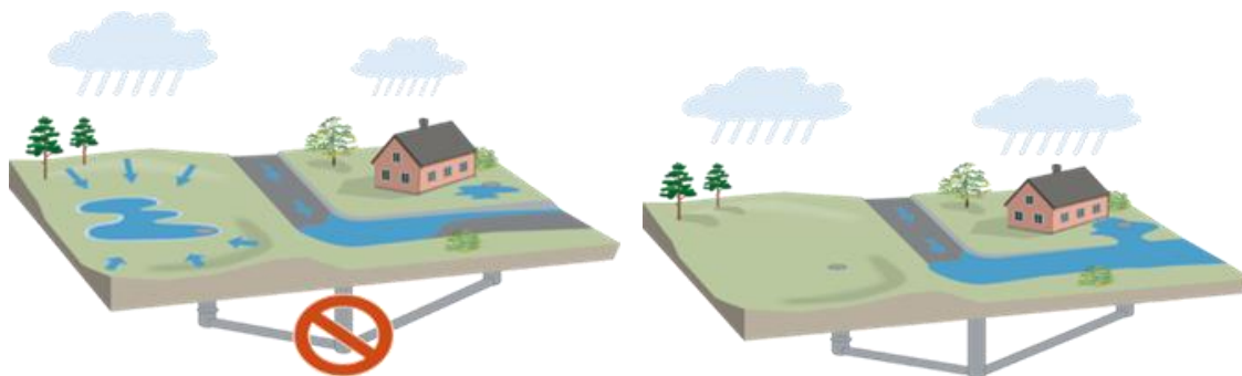
Figur 2-1. Illustration av skyfallsskartering med schablonmässig hantering av ledningsnätet (vänstra bilden) och med kopplad markavrinnings- och ledningsnätmodell (högra bilden).
