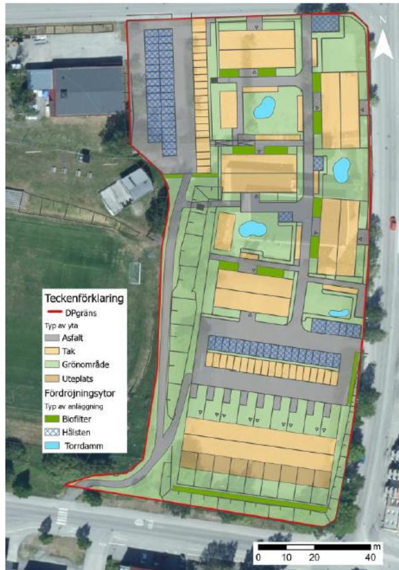
Figur 21. Förslag på placering av olika dagvattenanläggningar. Bild: Sweco.
