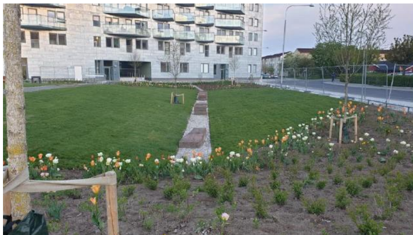
Figur 22. Exempel på nedsänk grönyta/torrdamm. Bild: Sweco.
