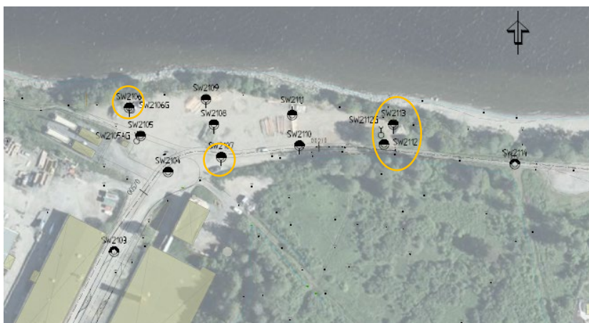
Figur 16. Bild över provtagningspunkter för markförorening och grundvattenrör, Inringade punkter visar de provpunkter där det finns överskridande värden för KM. Bild från PM Miljöteknisk markundersökning inför ny detaljplan vid Sälstensudde.
