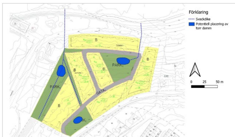
Figur 42. Förslagskiss på potentiella ytor som kan användas för exempelvis torrdammar eller ytor som tillfälligt kan tillåtas översvämmas. Potentiell placering av torr damm mot Brunnshusgatan Structor Norr AB
