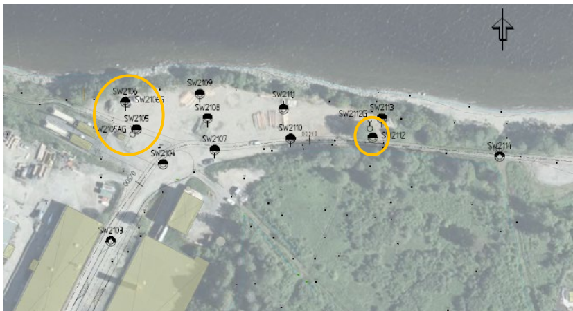
Figur 16. Bild över provtagningspunkter för markförorening och grundvattenrör, Inringade punkter visar grundvattenrörens placering.
