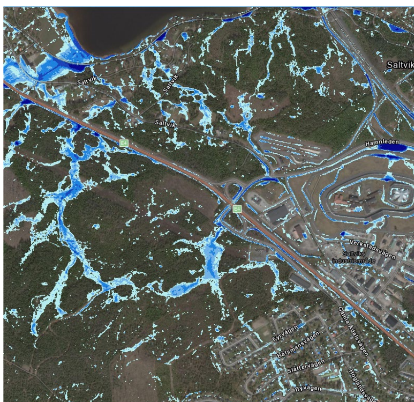
Figur 6. Maximala vattendjup vid 100-års regn med klimatfaktor 1.25. Skyfallskartering Härnösands kommun, 2020. (DHI)
